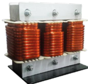
Los reactores de este tipo de filtro son especificados por el llamado factor de sobre tensión (p%), el cual provee la relación entre los voltajes del capacitor y el reactor, estableciendo el punto de resonancia del conjunto LC.
